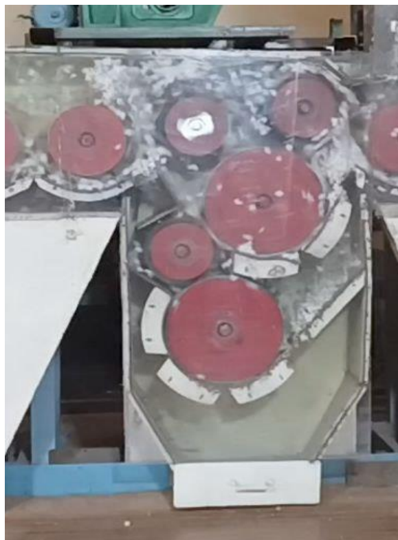
Рисунок 2 – Движение хлопка, выбрасываемого отделительным барабаном Figure 2 – Movement of cotton ejected by the separating drum
